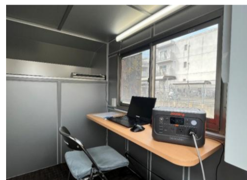
ポータブル電源は電気毛布8時間分スマートフォン24台分の給電が行える
