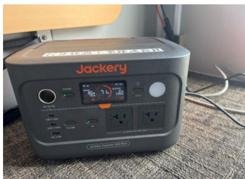
太陽光パネルからポータブル電源に充電し災害時も電力供給を可能にしている
